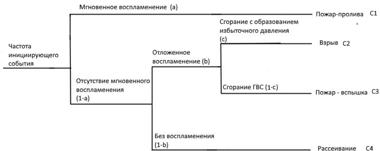
Рисунок 2 – «Дерево событий» при разрушении / частичной разгерметизации оборудования
